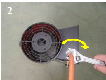
Kiristä liittimen mutteri nuolen osoittamaan suuntaan
