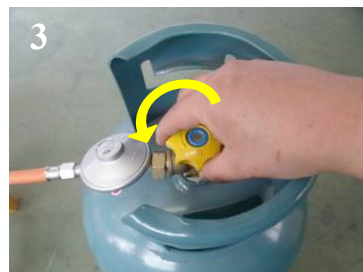
Avaa kaasupullon venttiili nuolen osoittamaan suuntaan
