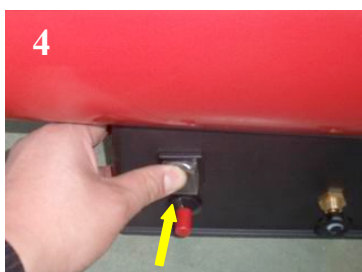
Aseta virtakytkin päälle asentoon "I"
